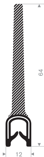
245.00.890 pvc + volrubber klembereik 1,5-4 mm
